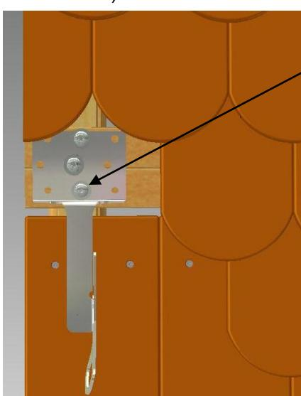
Schraubenlänge **L** wird in Abhängigkeit vom vorhandenen Dachaufbau festgelegt.
