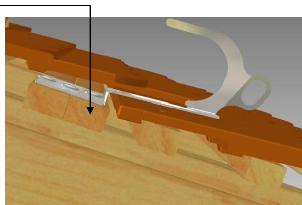
2. Befestigen des **LUX - top® SDH-B** gemäß der folgenden Montageskizze mittels der drei mitgelieferten Holzbauschrauben **8,0 x L mm** ohne Vorbohren auf der Lattung mittig in den Sparren (min. 6/14 cm; min. Festigkeitsklasse C 24 nach DIN EN 338).
