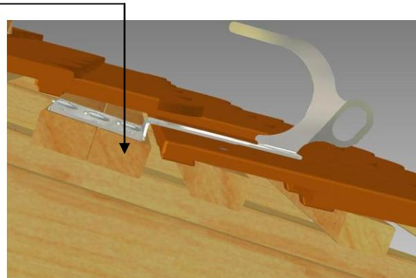
2. La fixation du crochet LUX - top® SDH-B s'effectue aux termes du schéma de montage ci-après à l'aide des trois vis à bois 8,0 x L mm fournies sans perçage d'un avant-trou sur le lattage au milieu du chevron (au moins 6/14 cm ; classe de résistance d'au moins C 24 selon DIN EN 338).
