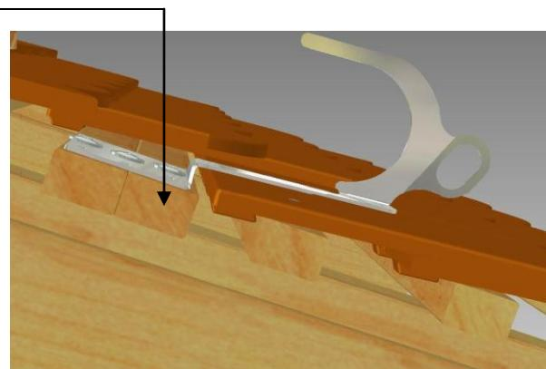
2. Bevestigen van de LUX - top® SDH-B volgens onderstaand montageschema met behulp van de drie meegeleverde houtbouwschroeven 8,0 x L mm zonder voorboren op de betengeling centraal in de dakspor (min. 6/14 cm; min. sterkteklasse C 24 volgens DIN EN 338).
